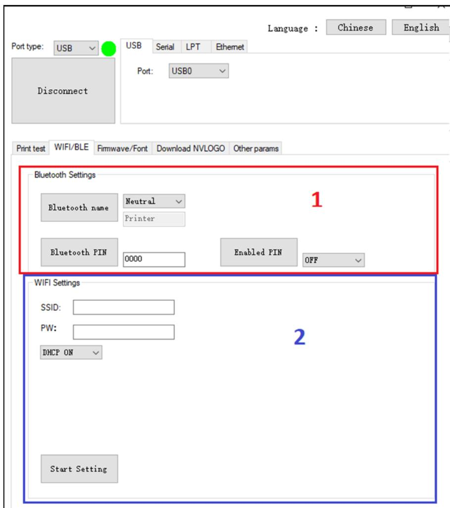
5. В красной зоне [1] можно работать с настройками Bluetooth («**Bluetooth Settings**»), а именно: задать имя устройства («**Bluetooth name**») и ПИН-код («**Bluetooth PIN**») при сопряжении.
