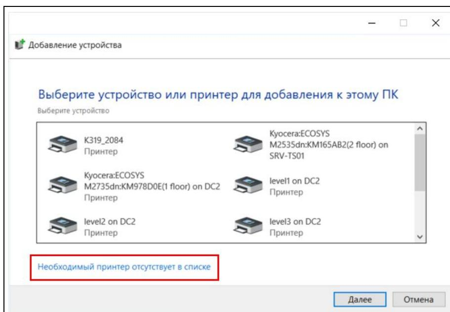
4. Выбрать пункт «Добавьте принтер, используя IP-адрес или имя узла» и нажать на кнопку «Далее».
