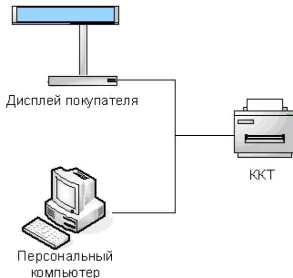
Рисунок 3. Подключение управляющих устройств к ККТ
